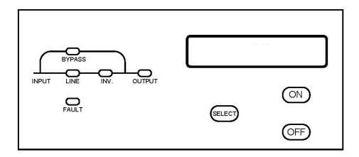
Индикаторы на панели управления указывают на режим работы ИБП
