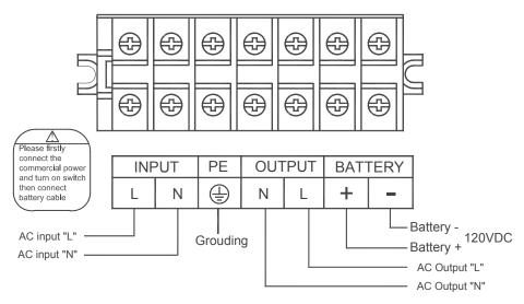
INPUT – вход, OUTPUT – выход, L – фаза, N – нейтраль, PE – защитное заземление
